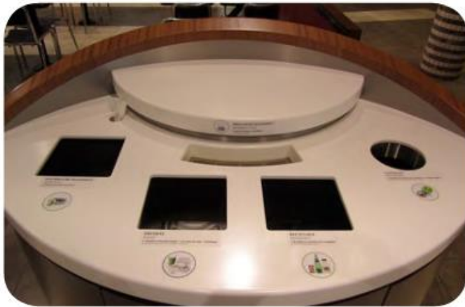
Figure 8 Îlot de récupération à cinq ouvertures (DESSAU, 2012)
