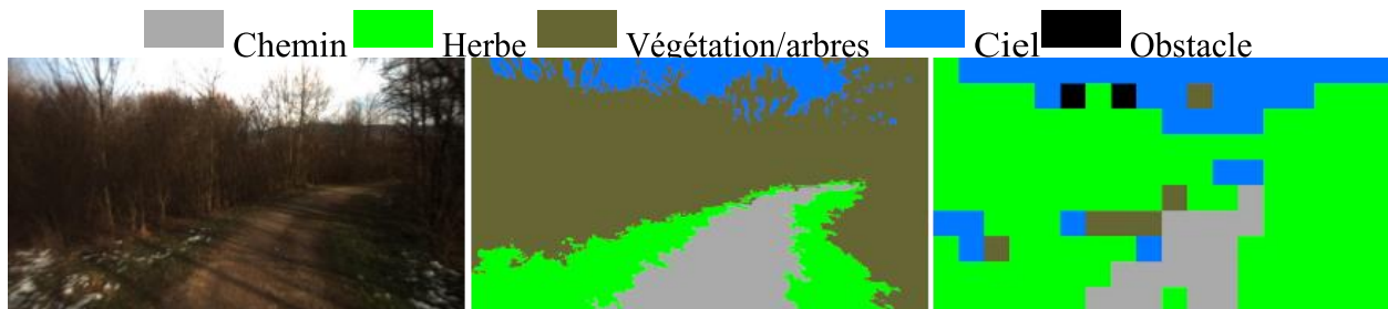
Figure 27: (gauche) Image originale (b378-61); (milieu) vérité terrain (GT); (droite) segmentation sémantique générée par l'architecture. Le IoU pour le chemin est +69 %.
