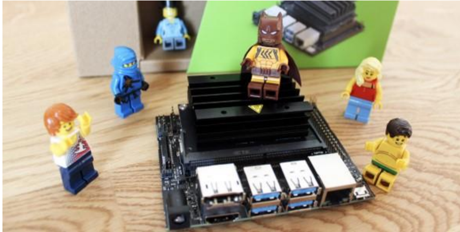
Figure 6: Carte mère Jetson Nano de NVIDIA, représenté avec des Lego pour démontrer sa petite taille
