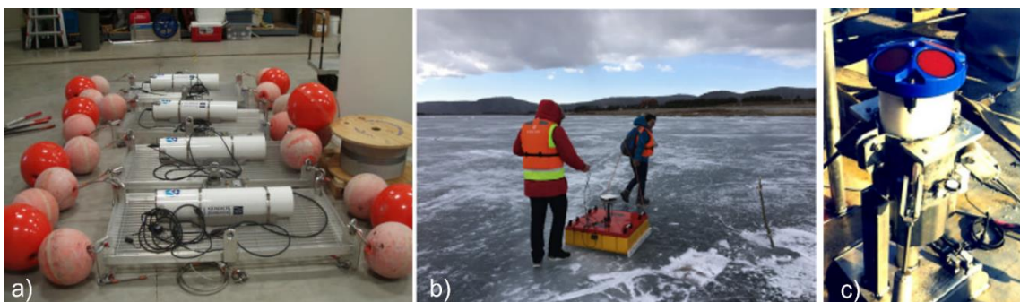
Figure 5 : Instruments d'acquisition terrestre. (a) Profileur de glace en eau peu profonde ( Shallow River Ice Profiler , SWIP) (tirée de Buermans et al. , 2011). (b) Radar à pénétration de sol ( Ground Penetrating Radar , GPR) (tirée de Fu et al. , 2018). (c) Courantomètre acoustique à effet Doppler ( Acoustic Doppler Current Profilers , ADCP) (tirée de Chave et al. , 2004).
