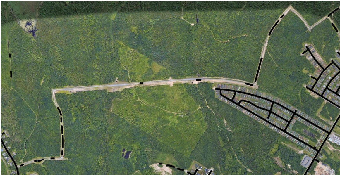
Figure 1: Exemple de discontinuités dans les routes détectées
