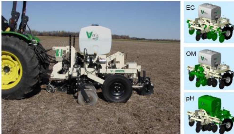
Figure 4. Capteur Veris MSP3 qui permet de calculer des données sur la conductivité électrique (EC), d'obtenir la mesure de pH du sol ainsi que des données sur les réflectances (PIR et R) pour obtenir des valeurs de matière organique du sol (OM).
